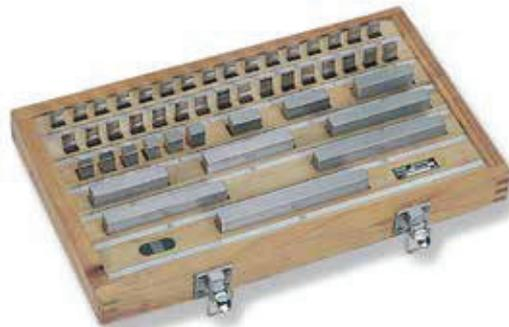
Composizione **blocchetti di riscontro pianparalleli** in acciaio indeformabile d'altissima qualità. Forniti in astuccio, numero di serie su ciascun blocchetto, eseguiti secondo norma UNI EN ISO 3650.
